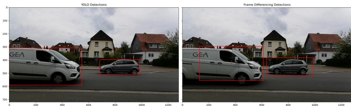
Abbildung 3: Erkennung von Objekten über YOLO und Frame Differencing
